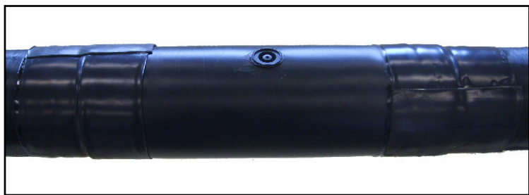
21. Pohled na kompletní pevnou spojku.
